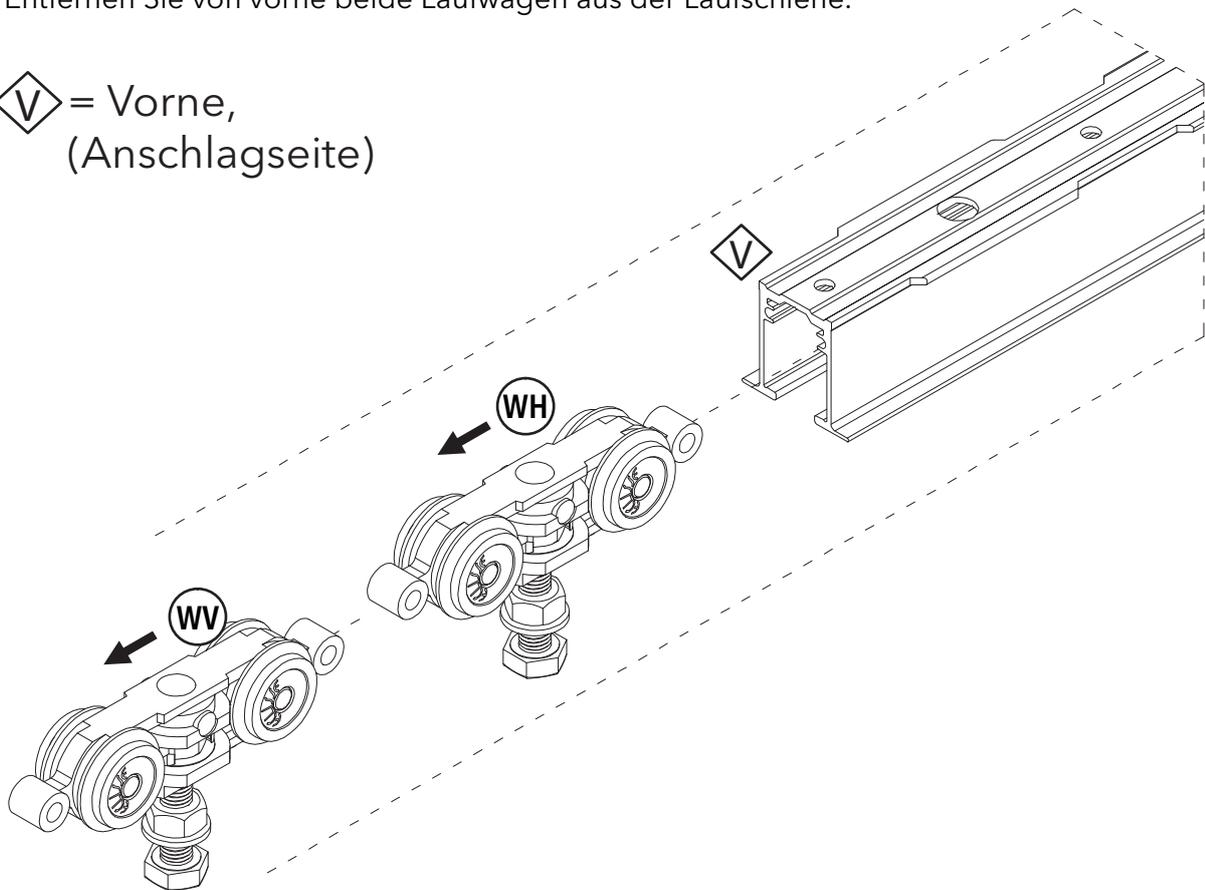
**5** Lösen Sie die Schraube des Mitnehmers (c). Montieren Sie den Mitnehmer hinten an den hinteren Laufwagen (WH).
