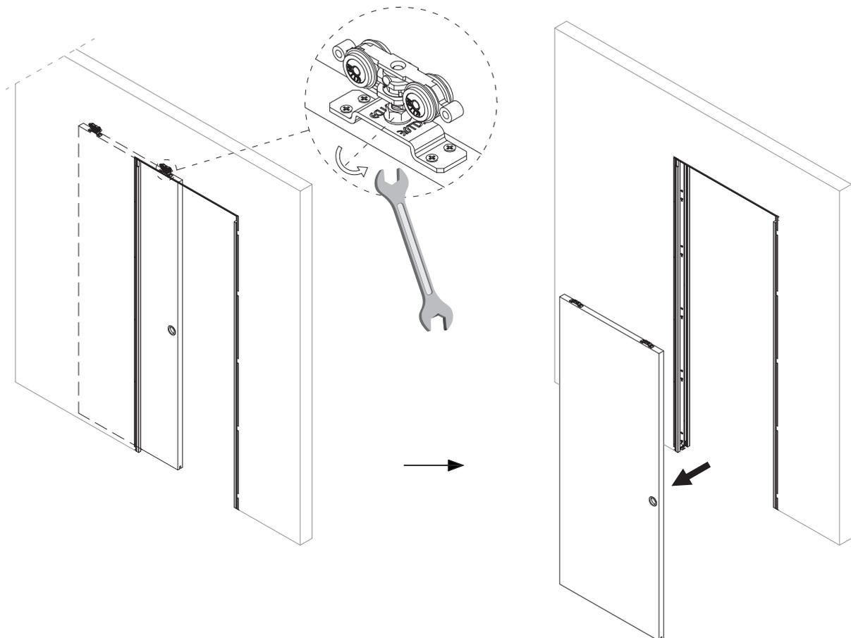
**2** Bauen Sie die Laufschiene aus und entfernen den Stopper im hinteren Bereich der Laufschiene. Je nach Baujahr der Schiene kann dieser Stopper unterschiedlich aussehen.
