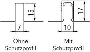
Ohne Schutzprofil      Mit Schutzprofil
