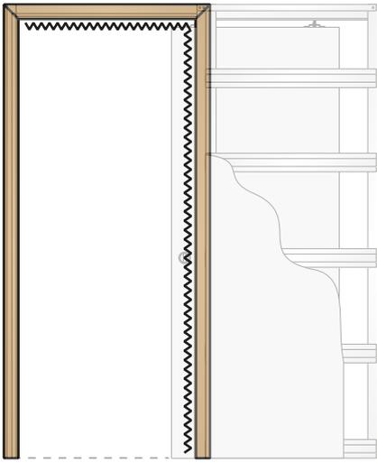
Erste Seite befestigen und oben Abstand zu Schienenträgerprofil (5 cm) prüfen.
